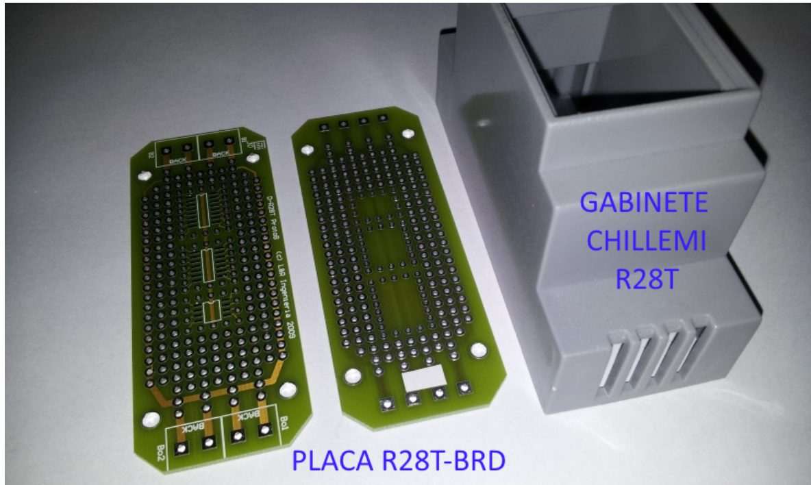
Figura 2.8 – Fotos Placa R28T-BRD y gabinete DIN Chillemi asociado
