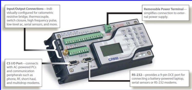
Logger Campbell Scientific CR850 – programacion en CRBASIC
